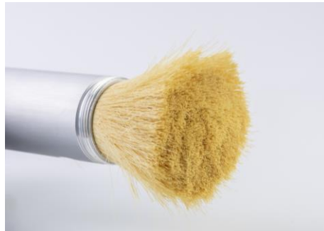
分離膜モジュール内部の ポリイミド中空糸
