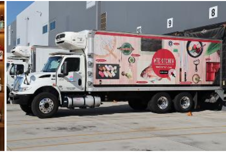
配送に使用する 温度帯管理ができるトラック
