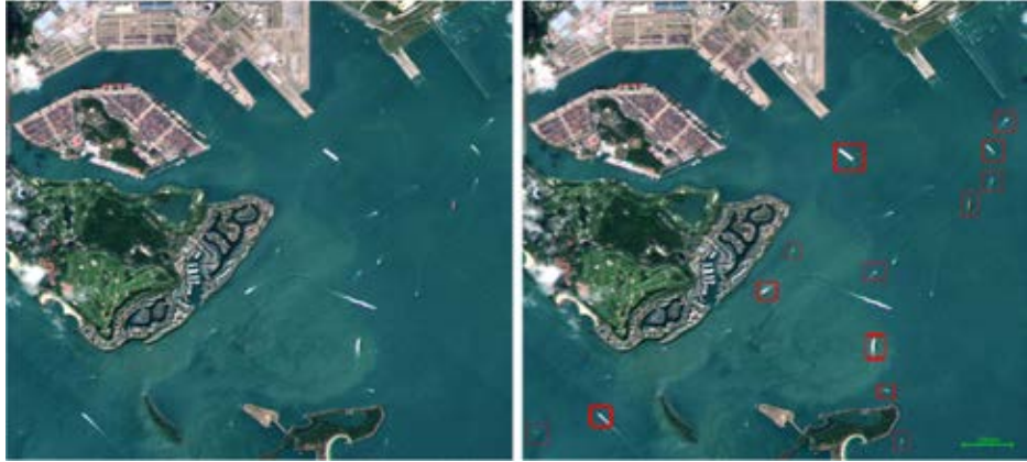
「GRUS-1」にて撮影したシンガポールの港湾エリア。AIを用いて貨物船を自動的に検出(画像右)
