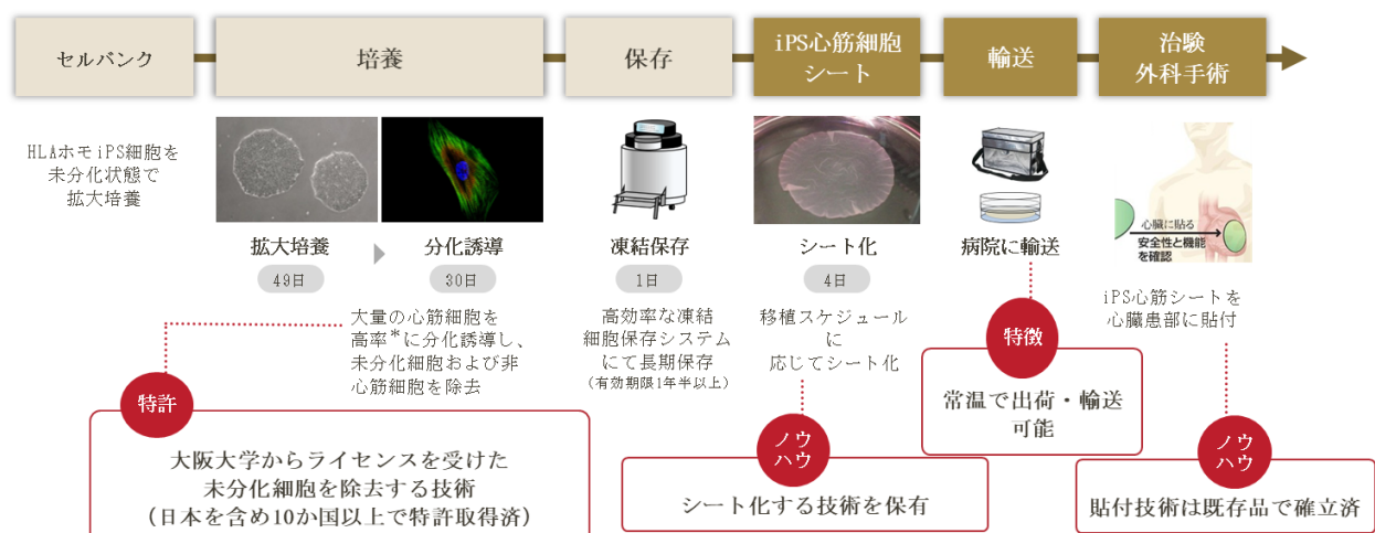
図4 ヒトiPS細胞由来心筋細胞シートの作製手順
