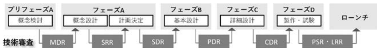
図5：システムエンジニアリング活動に準拠した開発の工程
