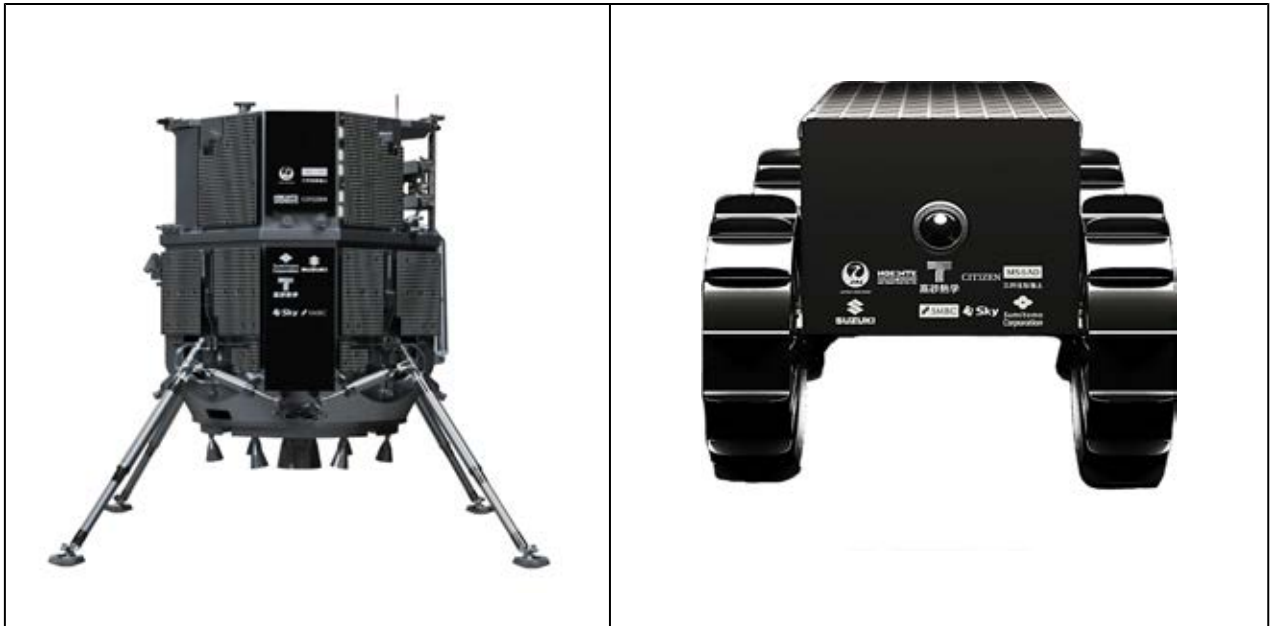
図2：当社が開発する月着陸船（ランダー：左）と月面探査車（ローバー：右）（それぞれの縮尺は異なります）
