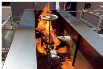
消火設備や可燃性流体を通す配管での使用を想定し、火災などで焼損した状態でも一定の性能が維持できているかどうかの性能を評価しています。
