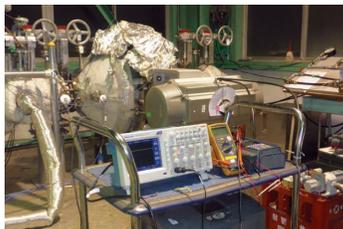
実際に製品が使用される温度環境を再現する試験装置で、電気ヒータにて最高700度の熱風を発生させ高温状態でバルブの性能や特性を評価しています。
